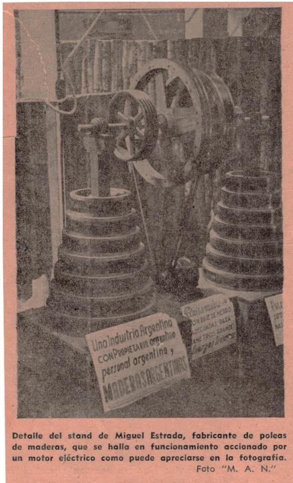
Detalle del stand de Miguel Estrada, fabricante de poleas de maderas, que se halla en funcionamiento accionado por un motor eléctrico como puede apreciarse en la fotografía.
